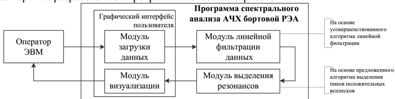
Рис. 1. Схема программы спектрального анализа АЧХ бортовой РЭА
