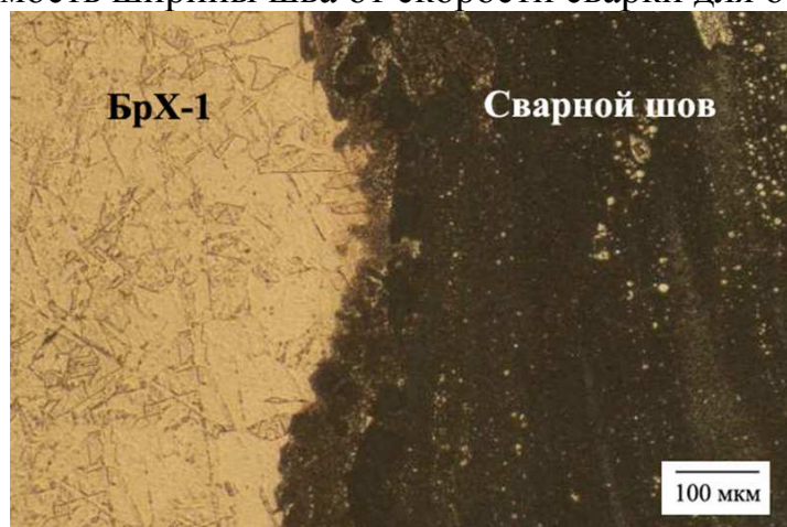
Рис. 4. Зона сплавления металла шва и бронзы образца №1
