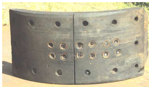
Рис. 1. Тормозная колодка, с встроенной системой охлаждения
