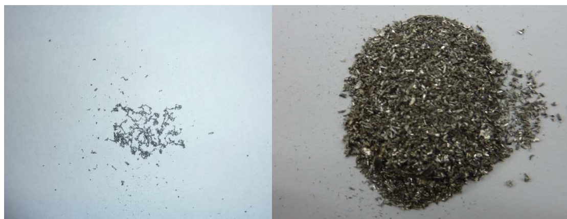
Рис. 5. Форма стружки (а- сталь 65, б - сталь Св-06Х19Н9Т)
