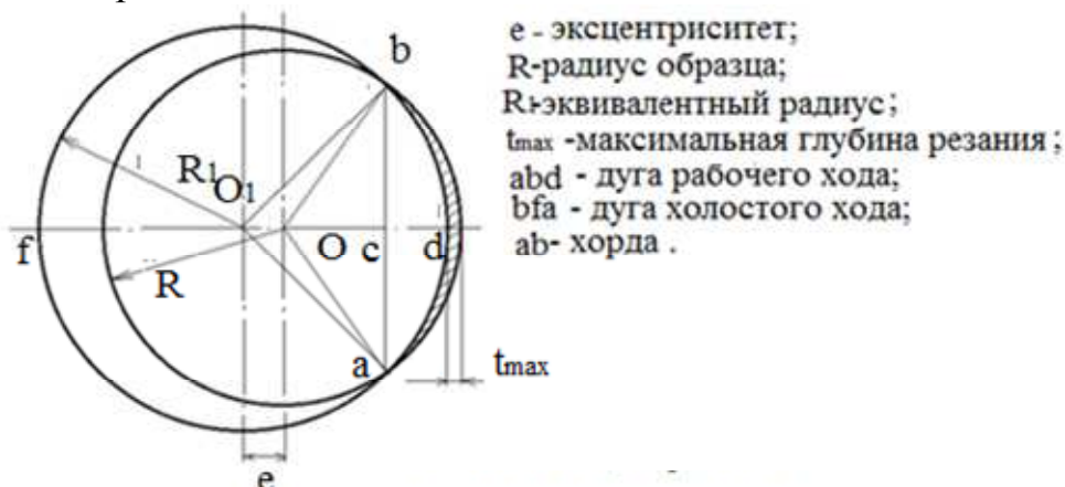
Рис. 2. Схема для определения величины эксцентриситета
