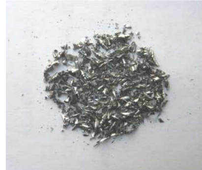
Рис. 8. Фотография стружки (увеличено)
