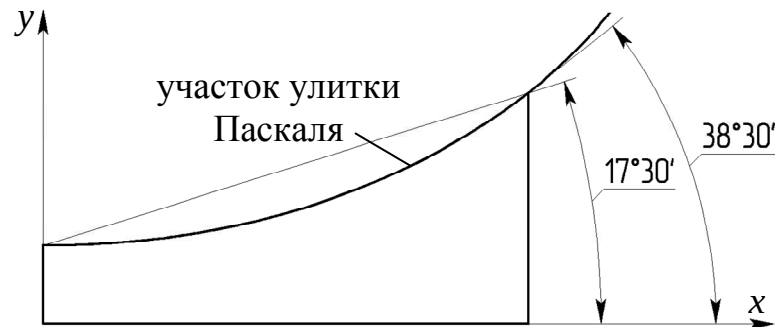
Рис. 3. Профиль кулачка, образованный по улитке Паскаля
