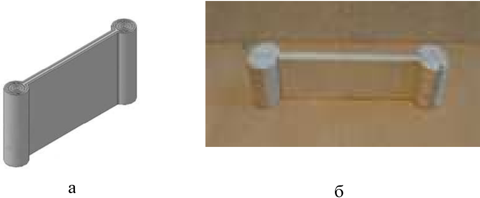
Рис. 1. Вставка гантелевидного сечения: а – компьютерная модель вставки; б – натуральный образец
