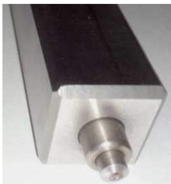
Рис. 2. Фотография алмазного наконечника
