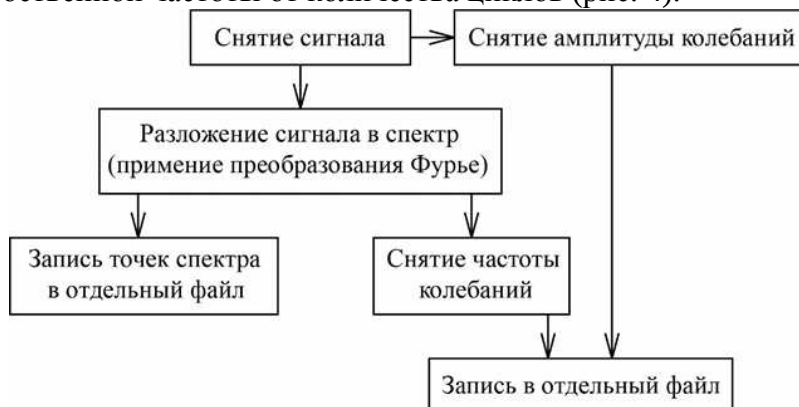
Рис. 3. Алгоритм программы снятия и записи показаний акселерометра
