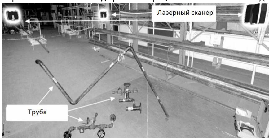
Рис. 1. Расположение сканеров для проведения послепроизводственных измерений
