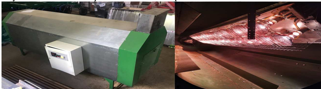
Рис. 1. Экспериментальная барабанная сушилка с ИК источниками тепла
