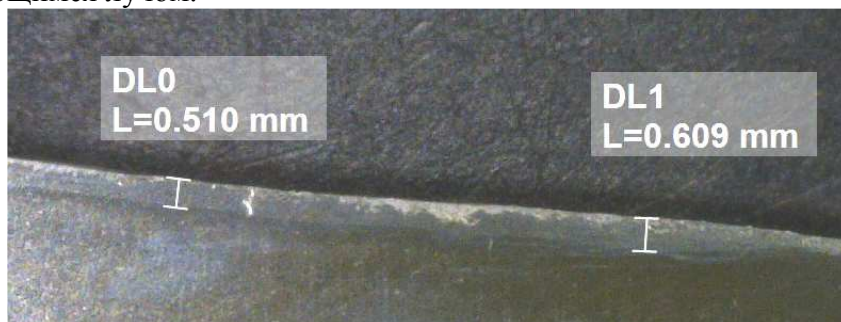
Рис. 1. Микрошлиф зоны легирования стали 20X13 колеблющимся лучом с частотой 217 Гц
