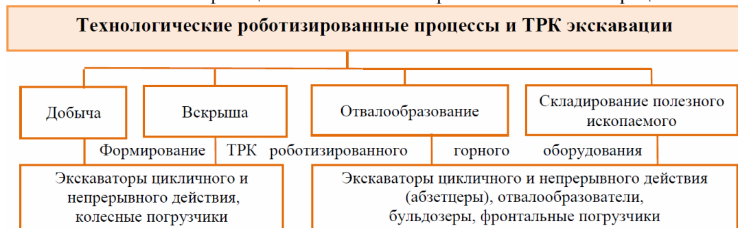
Рис. 4. Группа технологических роботизированных процессов экскавации горной породы с разделением на подгруппы и формирование ТРК из роботизированного горного оборудования
