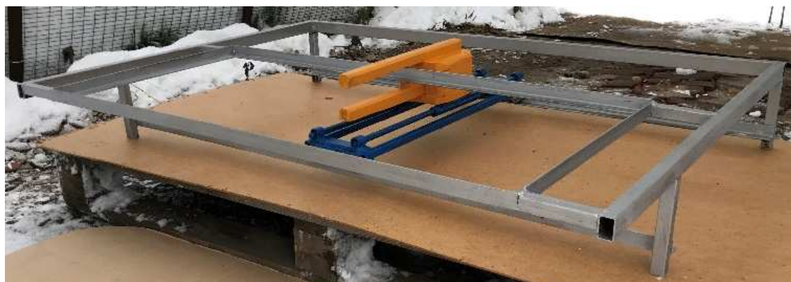
Рис. 11. Стенд аппарата ручной контактной сварки после антикоррозийной обработки
