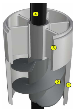
Рис. 1. Схема ступени осевого насоса: 1 – гильза (статор); 2 – шнек (рабочее колесо); 3 – направляющий аппарат (статор); 4 – вал
