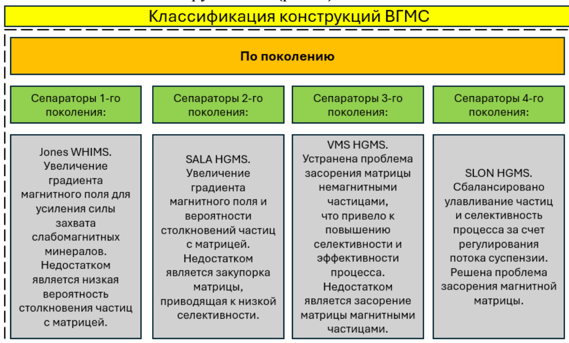
Рис. 1. Классификация конструкций ВГМС по поколениям
