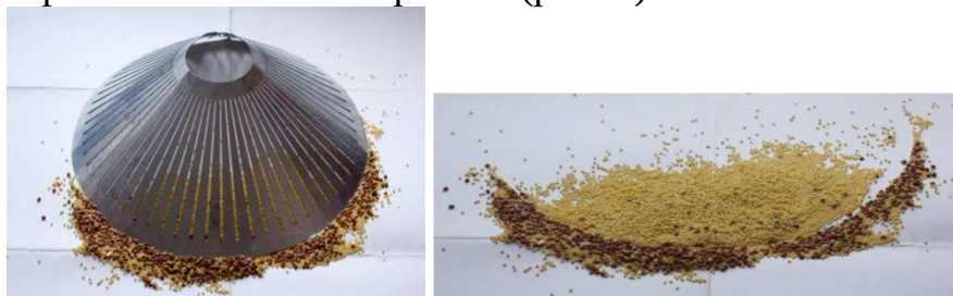
Рис. 1. Прототип конической поверхности разделения, оснащенной клиновидными щелями
