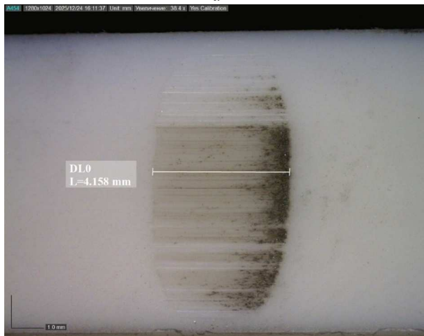
Рис. 1. Морфология поверхностей трения полимеров после испытаний: а – INKUPOM C, б – ZX-100K
