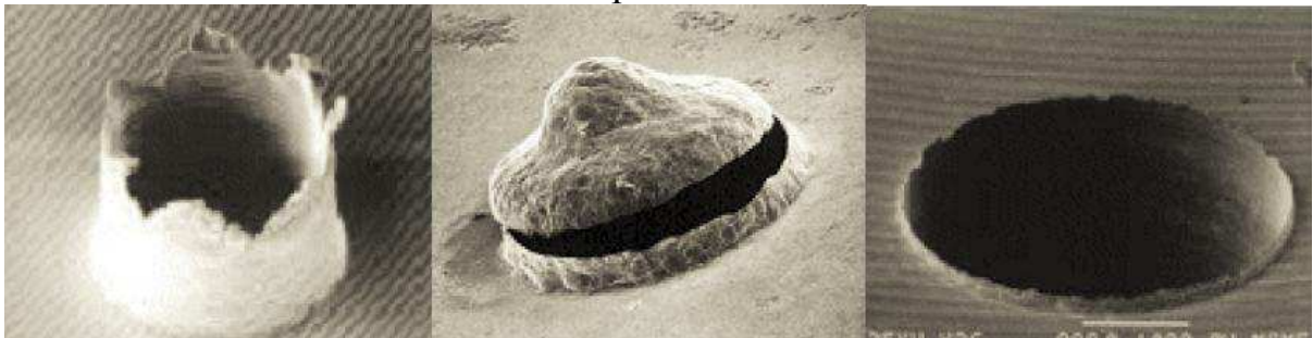
Рис. 3. Примеры заусенцев после сверления никелевых сплавов
