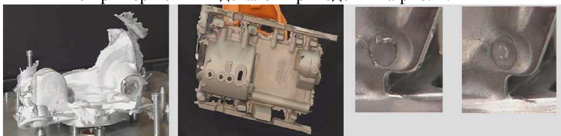
Рис. 1. Примеры литых деталей, требующих зачистки
