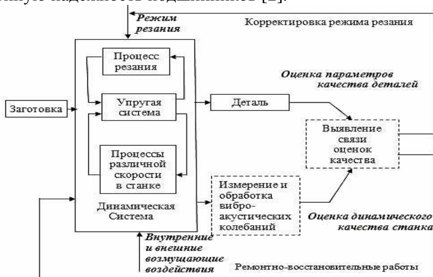
Рис. 1. Оценка технологической надежности автоматизированного станка на основе выявления связи его динамического качества со значениями параметров качества деталей
