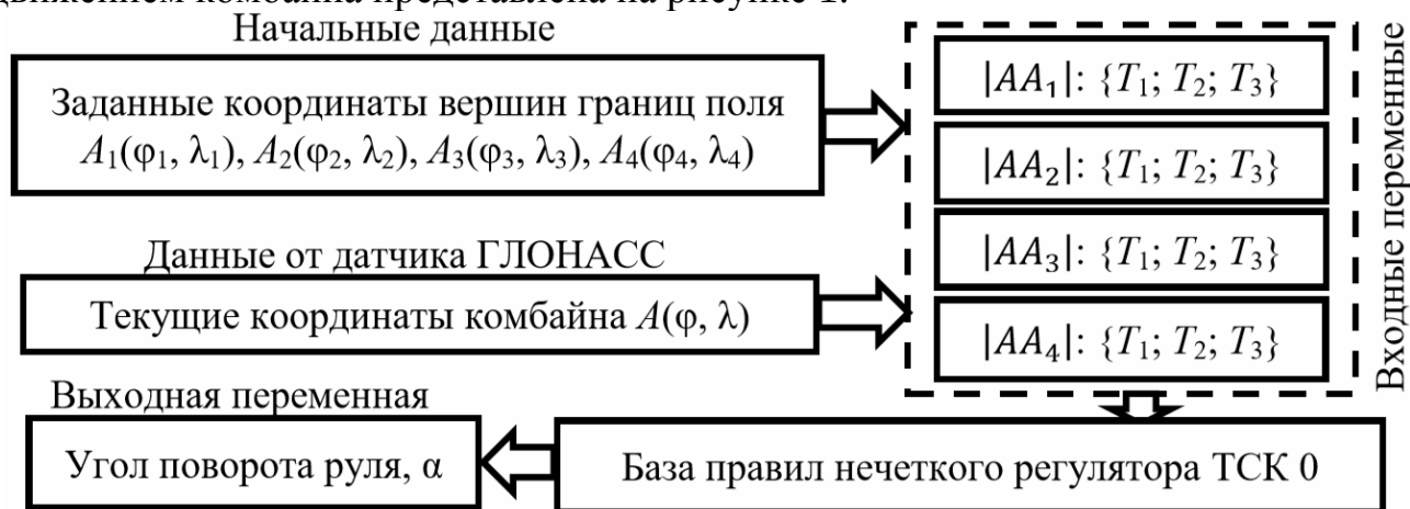
Рис. 1. Схема работы системы управления движением комбайна
