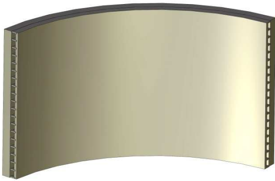
Рис. 1. Выделенный элемент турбинной лопатки с дефлекторной вставкой
