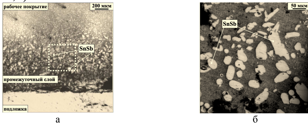
Рис. 1. Микроструктура промежуточного слоя из сплава Б83 после дуговой наплавки рабочего покрытия (а) и в исходном состоянии (б); выделена область для исследования и анализа размера кристаллов \beta -фазы
