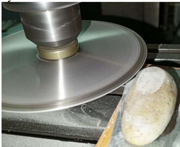
Рис. 3. Изготовление шлифа алмазным диском
