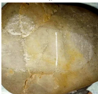
Рис. 4. Общий вид камня со шлифом (слева) и результаты измерения ширины борозды (справа): а, б – гранит; в, г – кварцит
