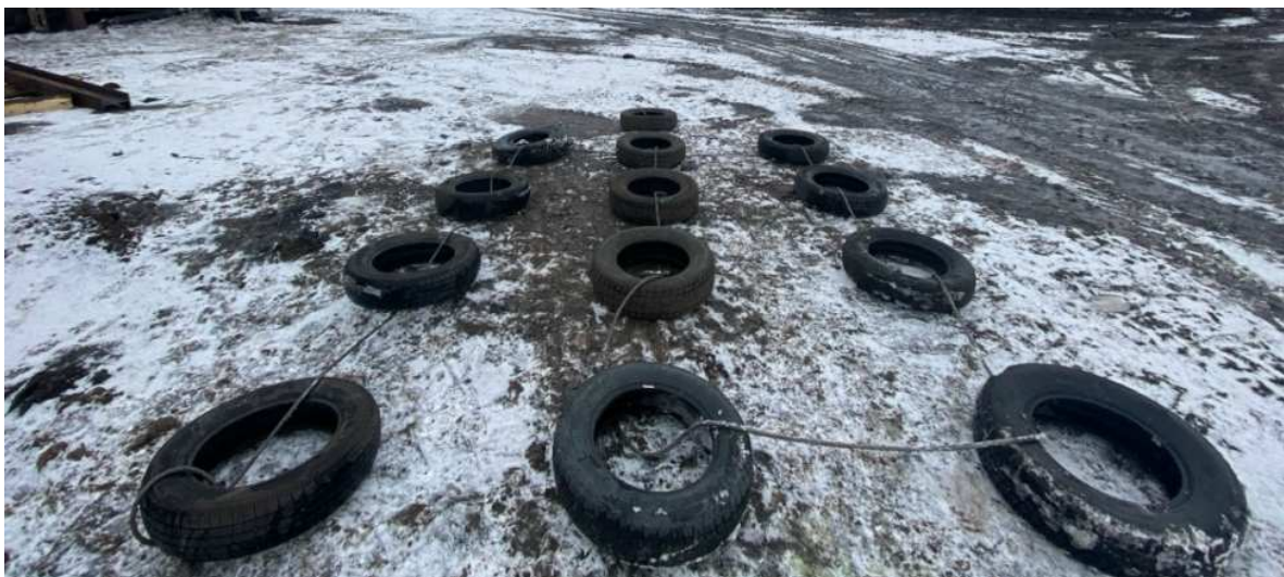
Рис. 2. Разложенные и увязанные в ряды автомобильные покрышки для борьбы с адгезией к опорной базе экскаватора ЭШ-6/45
