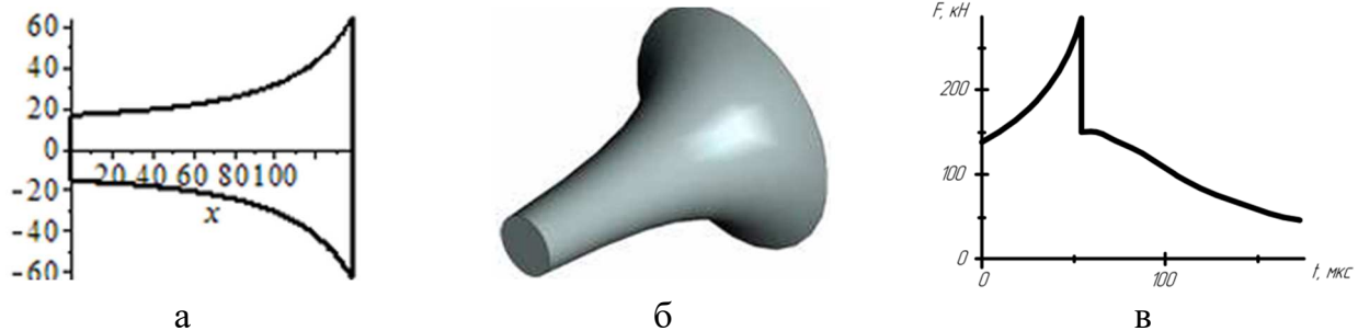
Рис. 1. Боёк в форме политропы вращения и его импульс: а – схема бойка; б – 3D-вид; в – график ударного импульса (составлено авторами)
