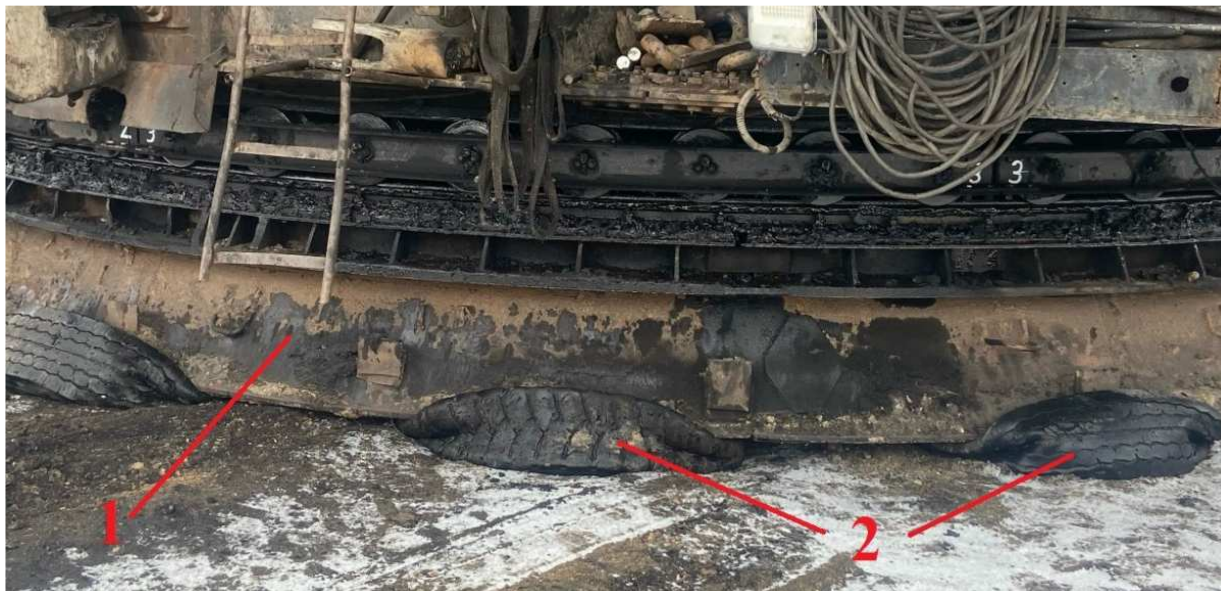
Рис. 3. Опорная база экскаватора ЭШ-6/45 на бывших в употреблении автомобильных покрышках: 1 – опорная база; 2 – автомобильные покрышки
