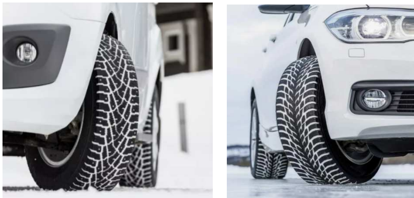
Рис. 3. Ориентация протектора зимних шин (перёд, зад)
