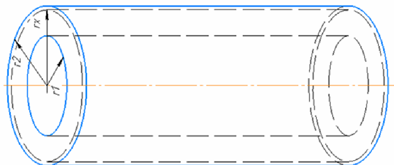
Рис. 5. Схема поршневого пальца для расчета параметров индуктора
