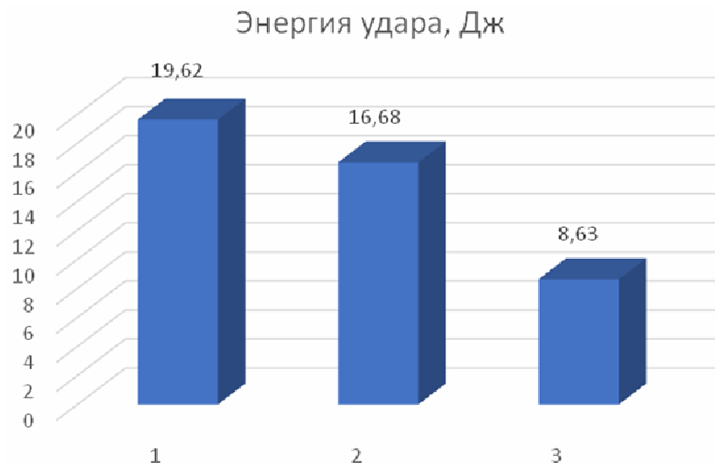
Рис. 3. Энергия удара бойками: 1 – цилиндрическим, 2 – коническим, 3 – псевдосферическим
