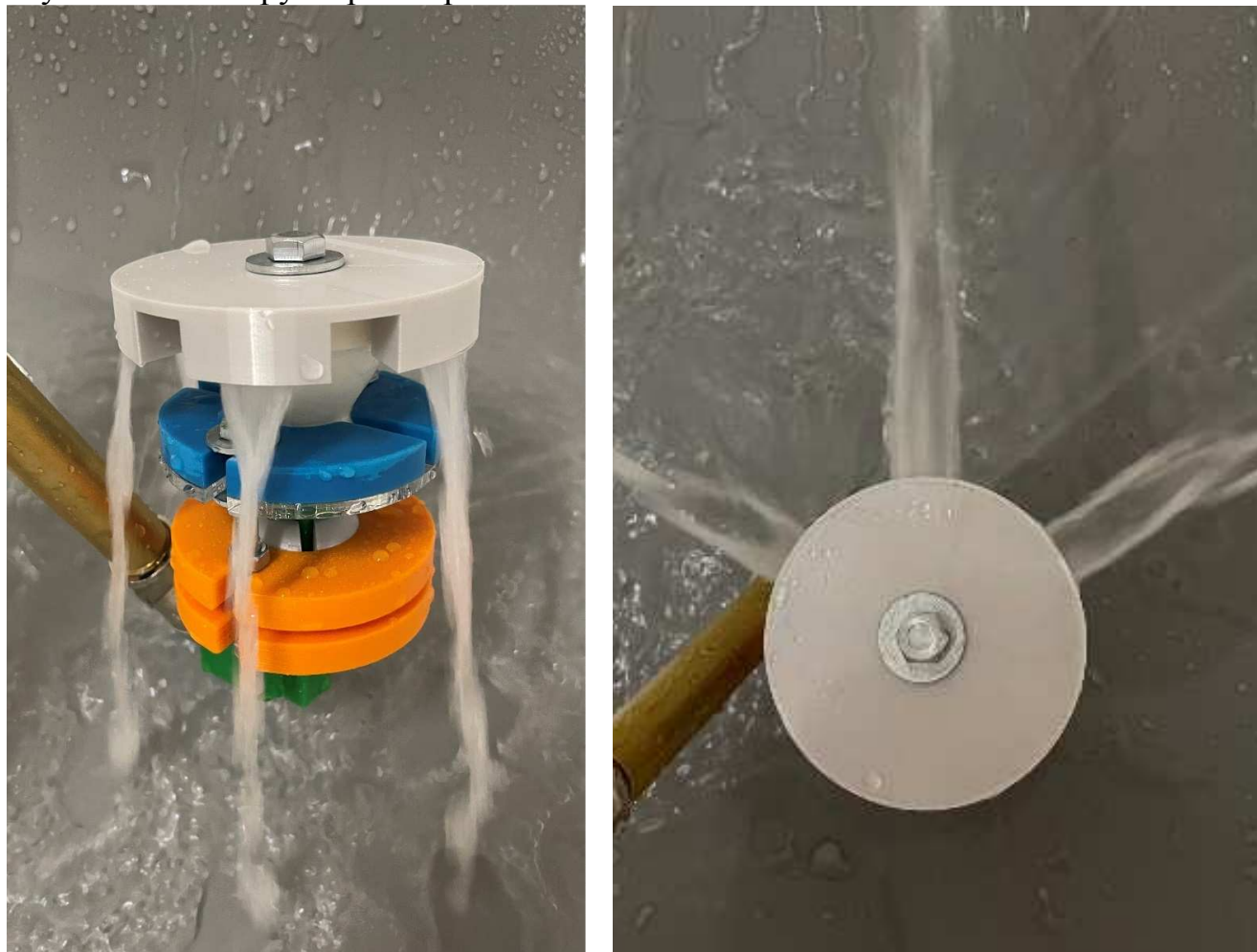
Рис. 2. Результаты гидравлических испытаний физической микромоделли струйной установки [6]
