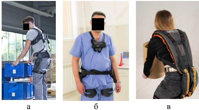
Рис. 1. Экзоскелеты для поддержки спины: а) модель «Раехо back»; б) модель промышленного экзоскелета, разработанного СибГМУ совместно с ООО «Технологическая компания «Биомеханические системы» в) модель «Lowebacker»
