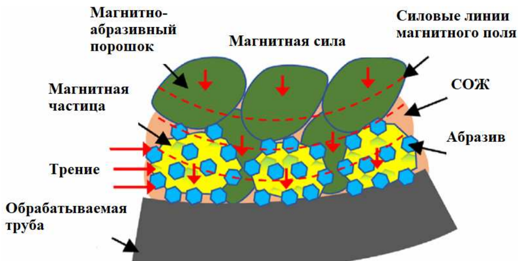
Рис. 1. Схема работы устройства
