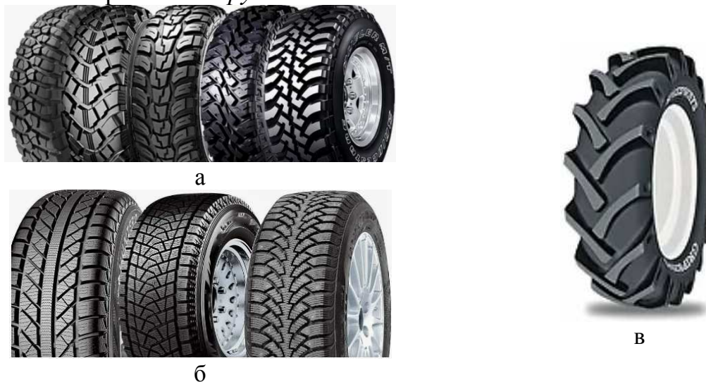
Рис. 1. Протекторы шин: а) для грунта; б) зимние; в) для тракторов
