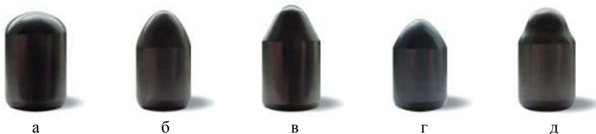
Рис. 1. Инденторы различной формы: а – сферический, б – баллистическая, в – полубаллистическая, г – параболическая (катенид [1]), д – сферическая выпукло-вогнутая [2]
