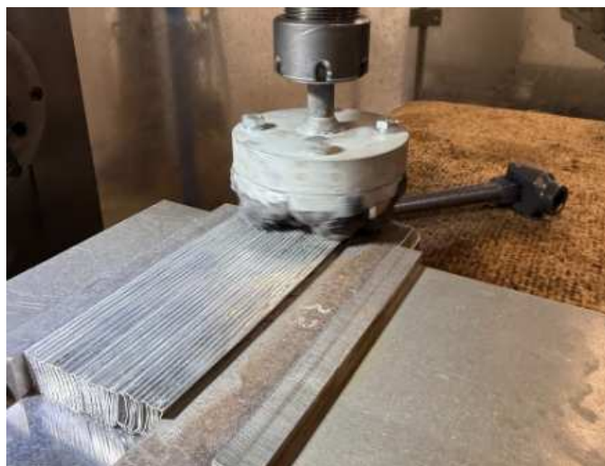
Рис. 1. Магнитно-абразивная обработка оребрения
