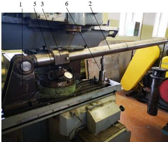
Рис. 1. Установка для экспериментальных исследований: 1 - кронштейн; 2 - рычаг; 3 - муфта; 5 - поворотный стол; 6 - устройство для плавного нагружения; 7 - подвеска с переменным грузом
