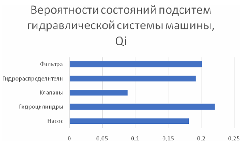
Рис. 4. Вероятности отказов подсистем гидравлической системы машины
