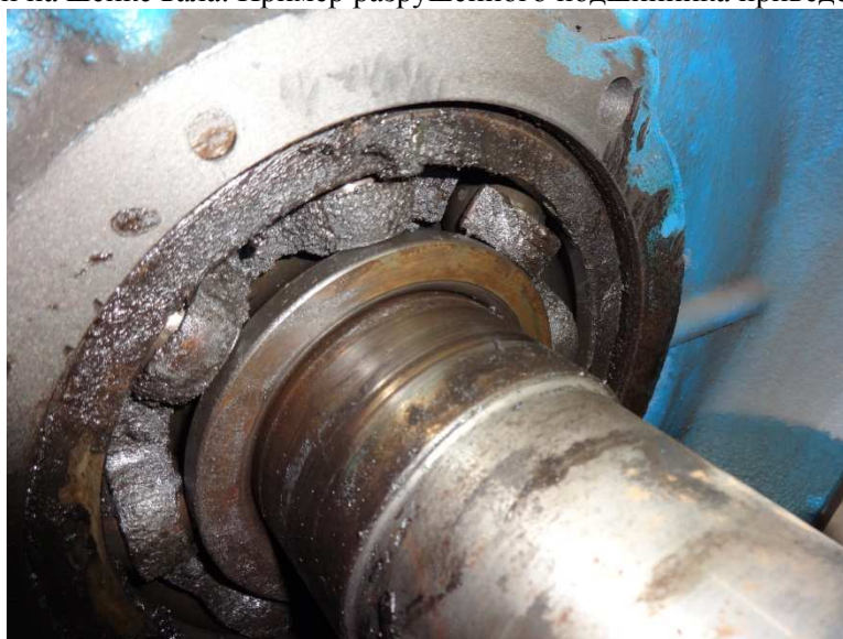
Рис. 2. Разрушение обоймы шарикового подшипника
