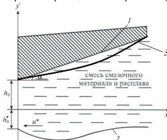
Рис. 1. Рабочая схема: 1 – контур наклонного ползуна (пяты); 2 – контур расплавленного подпятника; 3 – контур нестандартного опорного профиля
