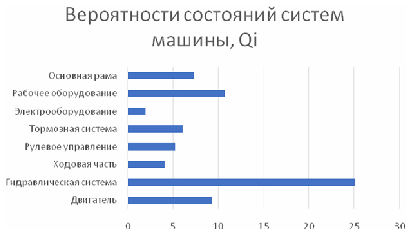
Рис. 3. Вероятности отказов систем машины.
