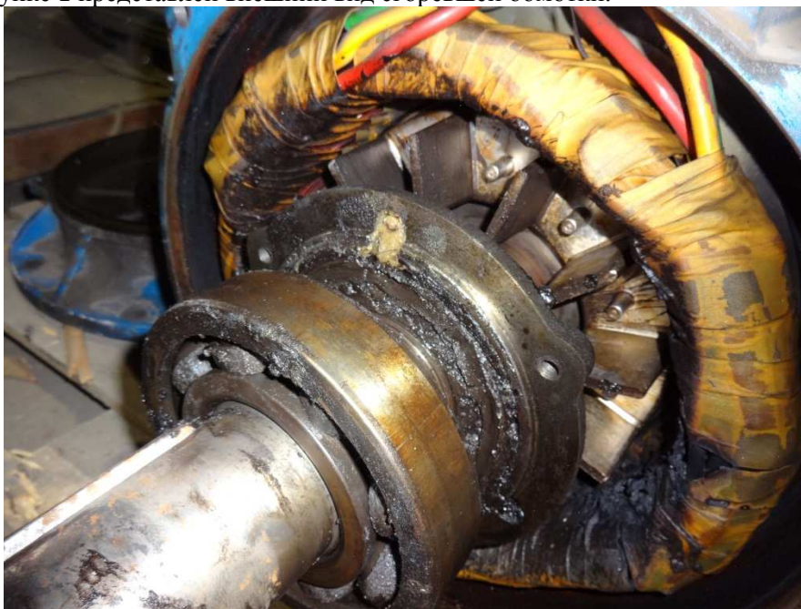
Рис. 1. Разрушение статорной обмотки электродвигателя
