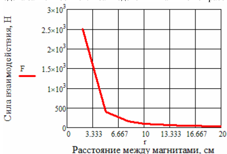
Рис. 1. Зависимость магнитного взаимодействия от расстояния между магнитами
