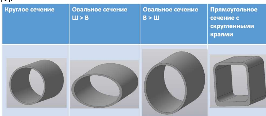
Рис. 2. Наиболее распространенные формы поперечного сечения фюзеляжа
