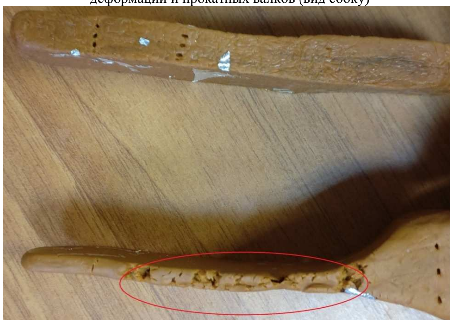
Рис. 2. Сравнение деформаций на пластилине после окончательного обжатия на моделях устройства деформации и прокатных валков (вид спереди)
