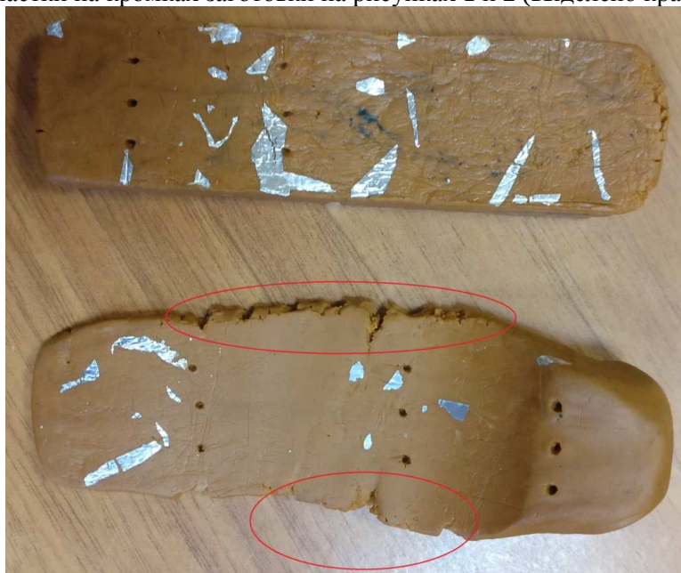
Рис. 1. Сравнение деформаций на пластилине после окончательного обжатия на моделях устройства деформации и прокатных валков (вид сбоку)
