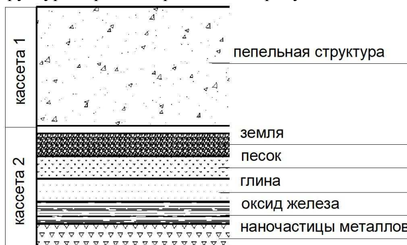
Рис. 1. Структура адсорбционного фильтра для процесса десульфуризации нефти и нефтепродуктов
