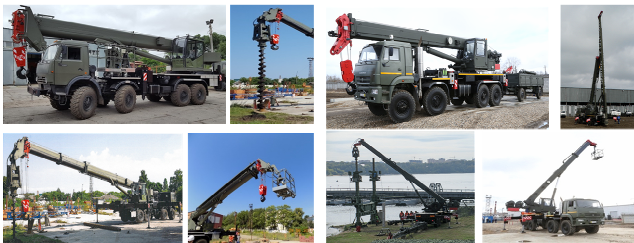
Установка для завинчивания свай УЗС-85
