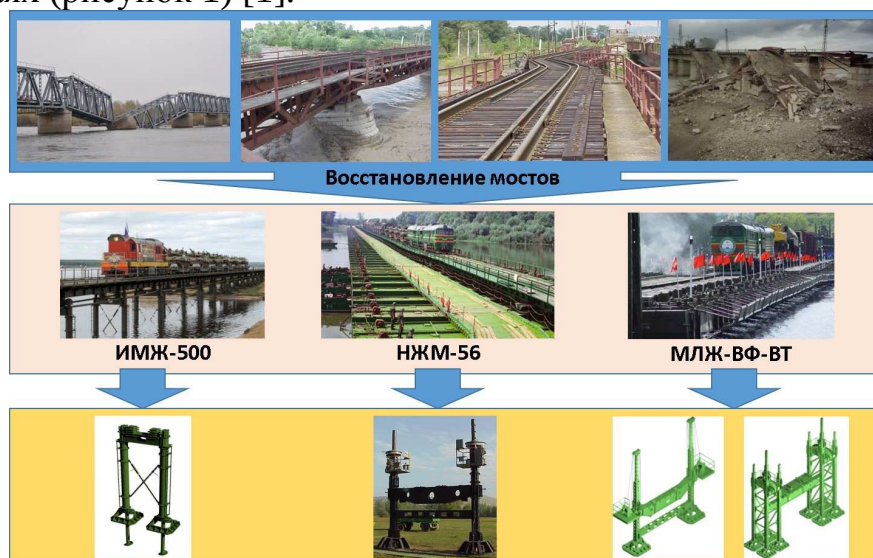
Рис. 1. Инвентарное имущество и наплавные железнодорожные мосты имеющие опоры на винтовых сваях
