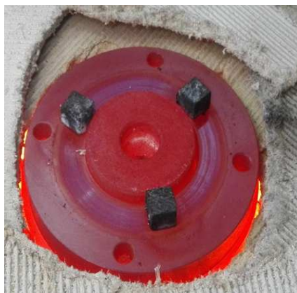
Рис. 3. Расположение образцов на нижнем диске после испытаний
