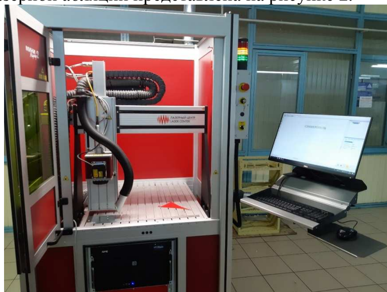
Рис. 2. Технологическая установка для лазерной абляции МиниМаркер 2-20А4 с волоконным иттербиевым лазером, IPG Photonics
