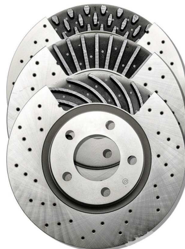
Рис. 2. Вентилируемые тормозные диски с различной геометрией вентиляционных каналов
