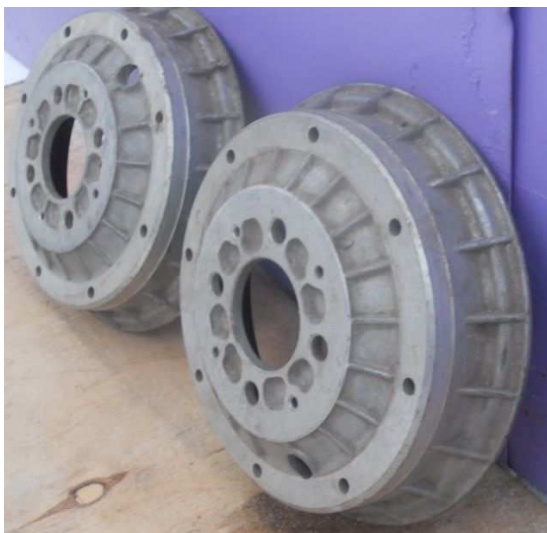
Рис. 1. Оребренный тормозной барабан
