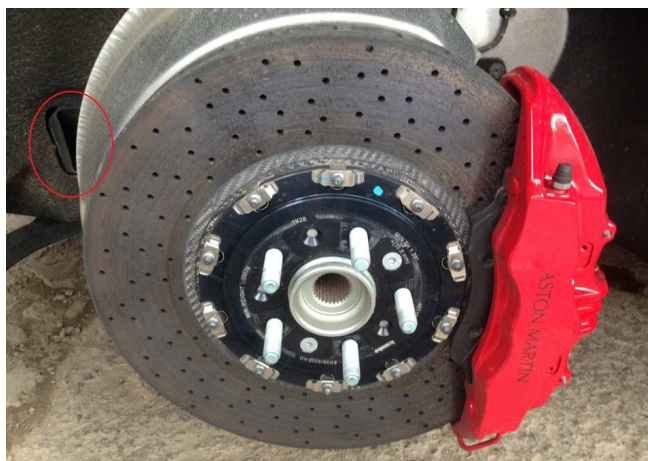
Рис. 3. Дефлектор для обдува тормозного диска
