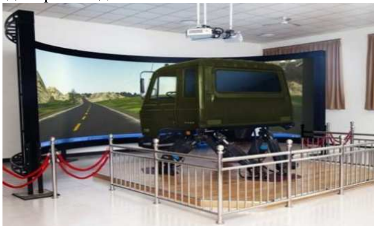
Рис. 3. Автотренажер на платформе Гью-Стюарта [3]
