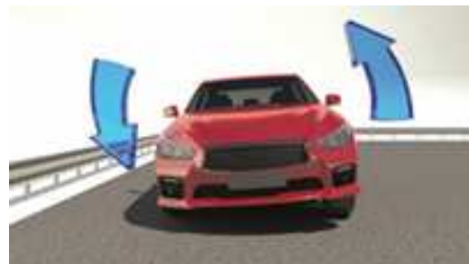
Рис. 2. Раскачка кузова в поперечной плоскости
