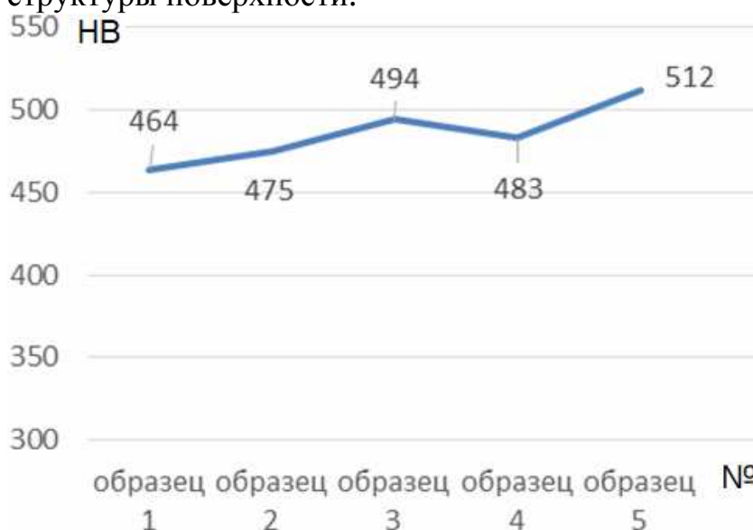
Рис. 2. Микротвердость по Бринеллю образцов после лазерной обработки
