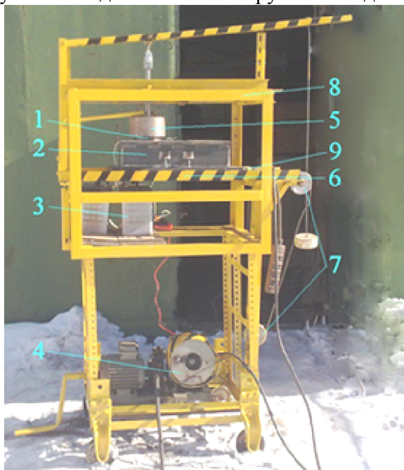
1 – кольцо с грунтом; 2 – имитатор поверхности рабочего органа; 3 – источник питания, 4 – тяговая лебедка; 5 – обойма; 6 – тележка; 7 – блоки; 8 – рама; 9 – датчик измерения усилия срыва
