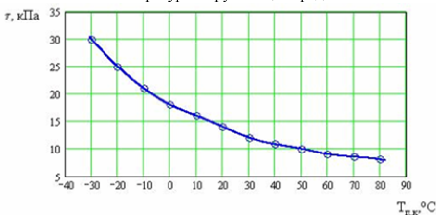
Рис. 3. Изменение напряжений сдвига грунта по поверхности имитатора от температуры поверхности контакта
