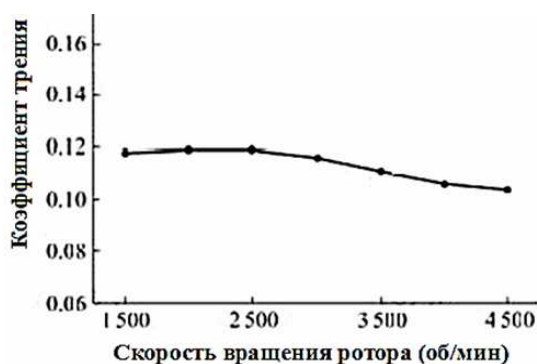
Рис. 6. Зависимость коэффициента трения от скорости вращения диска сцепления из КМК в условиях «мокрого» трения
