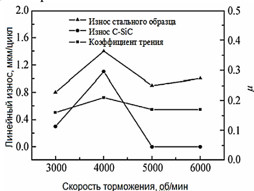
Рис. 7. Зависимости линейного износа и коэффициента трения ( \mu ) от скорости вращения для пары трения «КМК-сталь» в условиях «мокрого» трения
