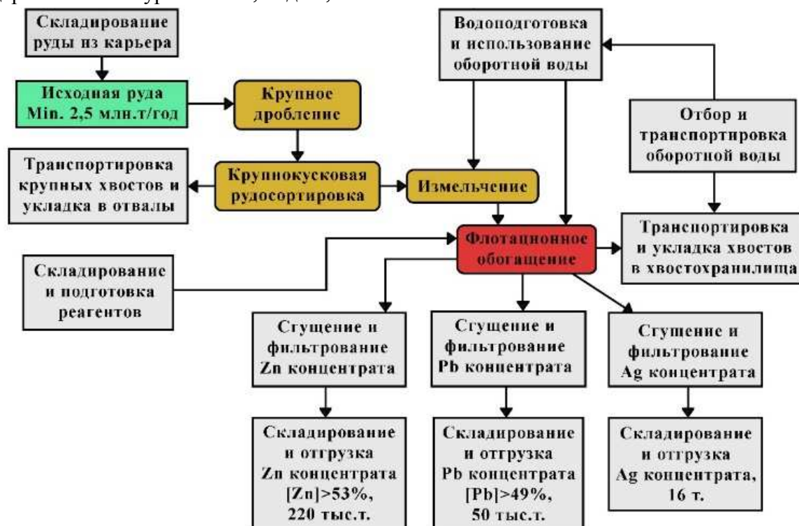
Рис. 1. Укрупненная технологическая схема переработки серебросодержащих свинцово-цинковых руд месторождения «Павловское»
