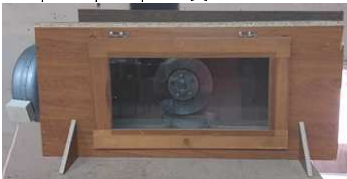
Рис. 1. Стенд для испытания теплоотвода тормозных дисков
