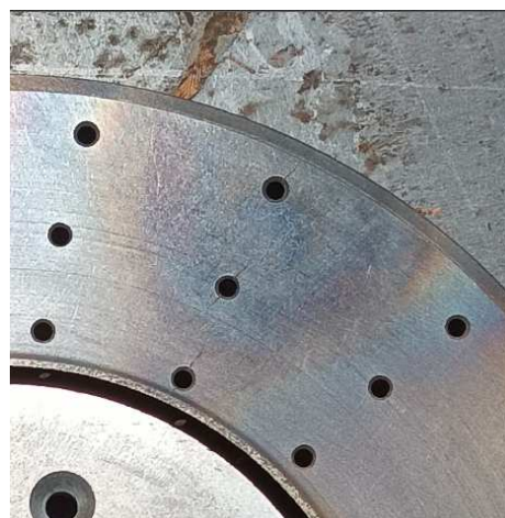
Рис. 6. Перегретый тормозной диск с микротрещинами
