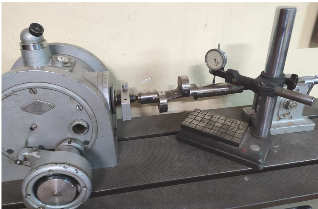
Рис. 6. Измерение радиального биения опорных шеек коленчатого вала
