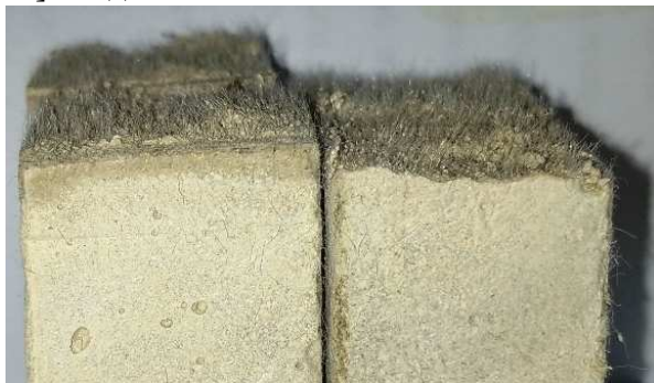
Рис. 1. Излом образца бетона армированного полипропиленовой фиброй
