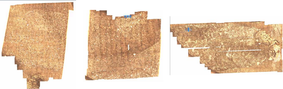
Рис. 7. Виды разрушений образца при нагрузках 10, 20 и 30 Н
