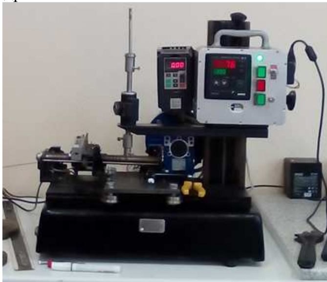
Рис. 3. Машина трения возвратно-поступательного типа МТВП
